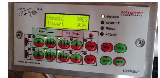
Bedientableau mit Vorwahlzähler (Art. Nr. 8P408-N)
