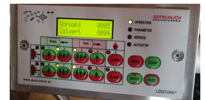
Bedientableau mit Vorwahlzähler (Art. Nr. 8P408-N)
